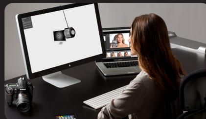
**Erstellung von Monitorprofilen:** Drehen Sie den Lichtdiffuserarm, und stellen Sie das integrierte Gegengewicht auf simplen Tastendruck entlang dem USB-Kabel ein. So können Sie im Handumdrehen Monitorprofile erstellen.
