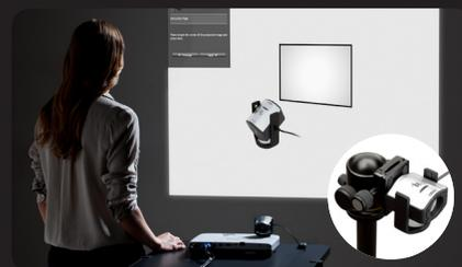
**Erstellung von Projektorprofilen:** Verwenden Sie den Lichtdiffuserarm als Gerüsteständer, um das Gerät auf einem Tisch vor der Projektionsfläche zu platzieren, oder verwenden Sie das integrierte Stativgewinde für größere Räume.
